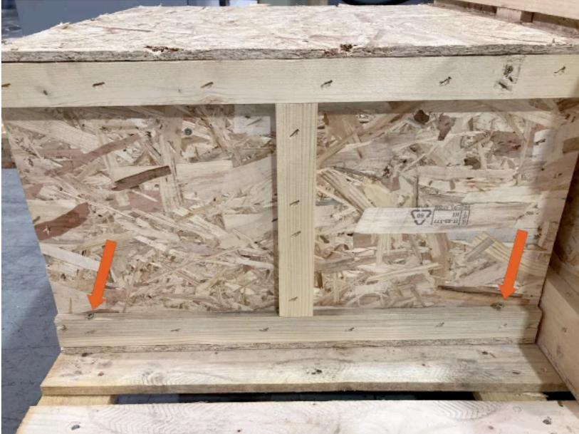
El embalaje se fija al palet mediante topes de fijación. Quítelos antes de intentar moverlo.
