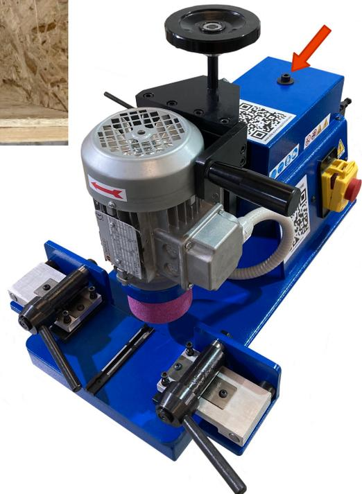
Luego afloje el tornillo de fijación del carro.
