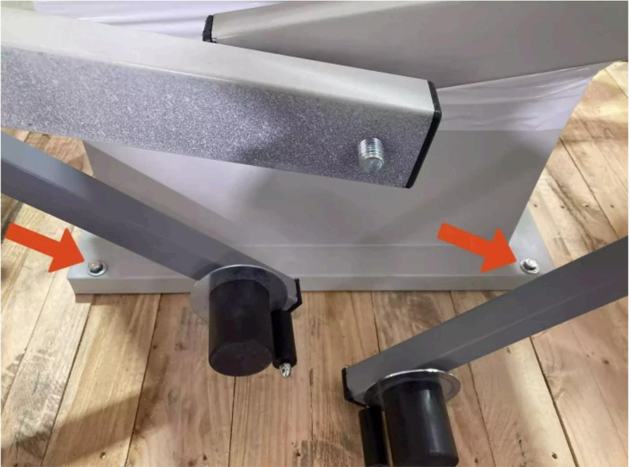
Une fois la machine à son emplacement définitif, vous pouvez également retirer le film protecteur et autres protections des composants, qui maintiennent et empêchent la machine de bouger.
