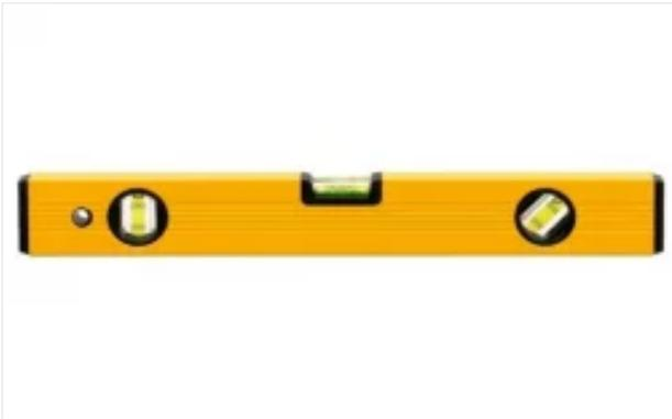
Una mala nivelación de la máquina puede provocar vibraciones no deseadas y un desgaste prematuro de las guías lineales.
