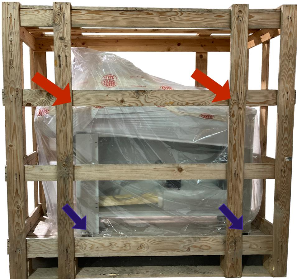
Una vez ubicada la máquina en su ubicación definitiva, también ya puede retirar la película protectora y demás protecciones de los componentes, que fijan e impiden que la máquina se mueva.
