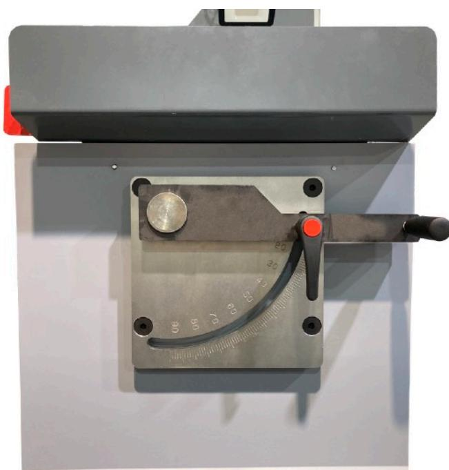
**Grados de la cuchilla** rápidos y fáciles de ajustar mediante palanca graduada de 0° a 90°
