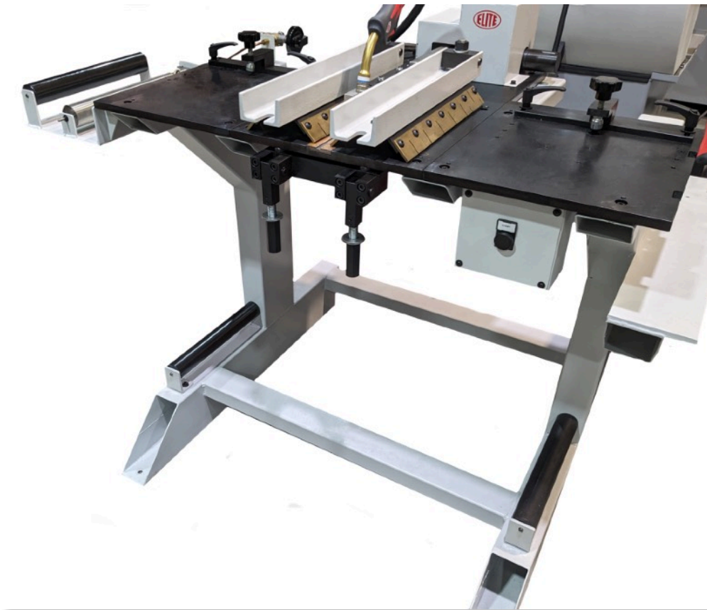
Rodillos de transporte de la sierra de cinta / Band saw transport rollers
