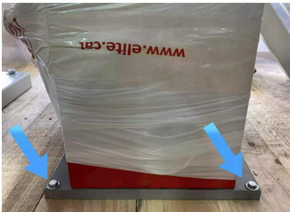
**Uma vez deslocada a máquina até ao seu destino final de trabalho, deve fixar a máquina ao solo através dos 4 parafusos colocados na base de suporte da máquina.**
