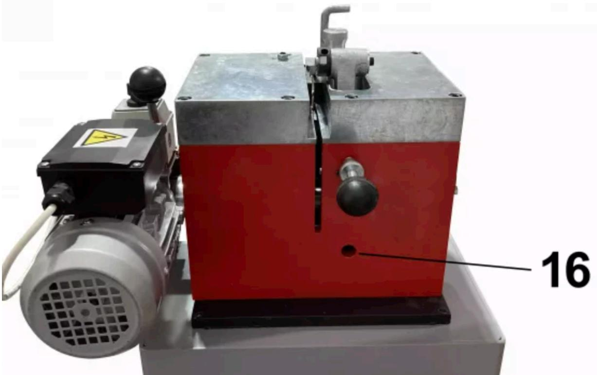
16. Furo para apertar/afrouxar o parafuso de fixação do came seletor de ajuste direita-esquerda ou direita-esquerda-reta.
